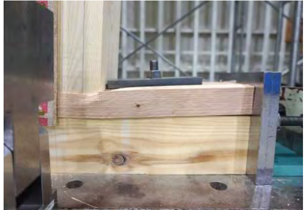
右柱脚部 下枠へのめり込み
