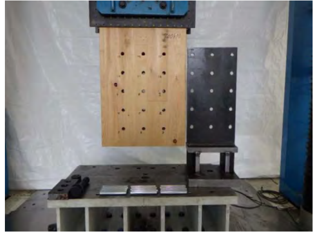
写真8 試験終了後の状況 (接合部試験体B, 単調)
