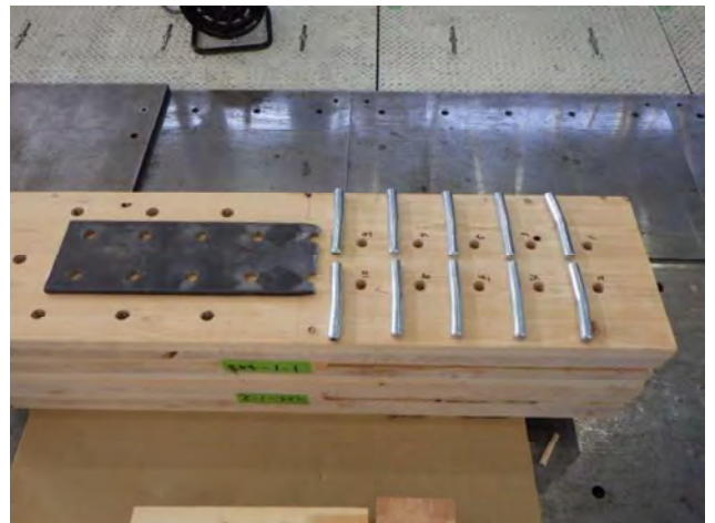
写真6 試験終了後の状況 (接合部試験体A, 一方向繰返し)
