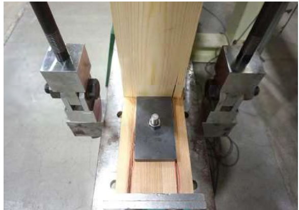
右柱脚部 下枠の割裂
