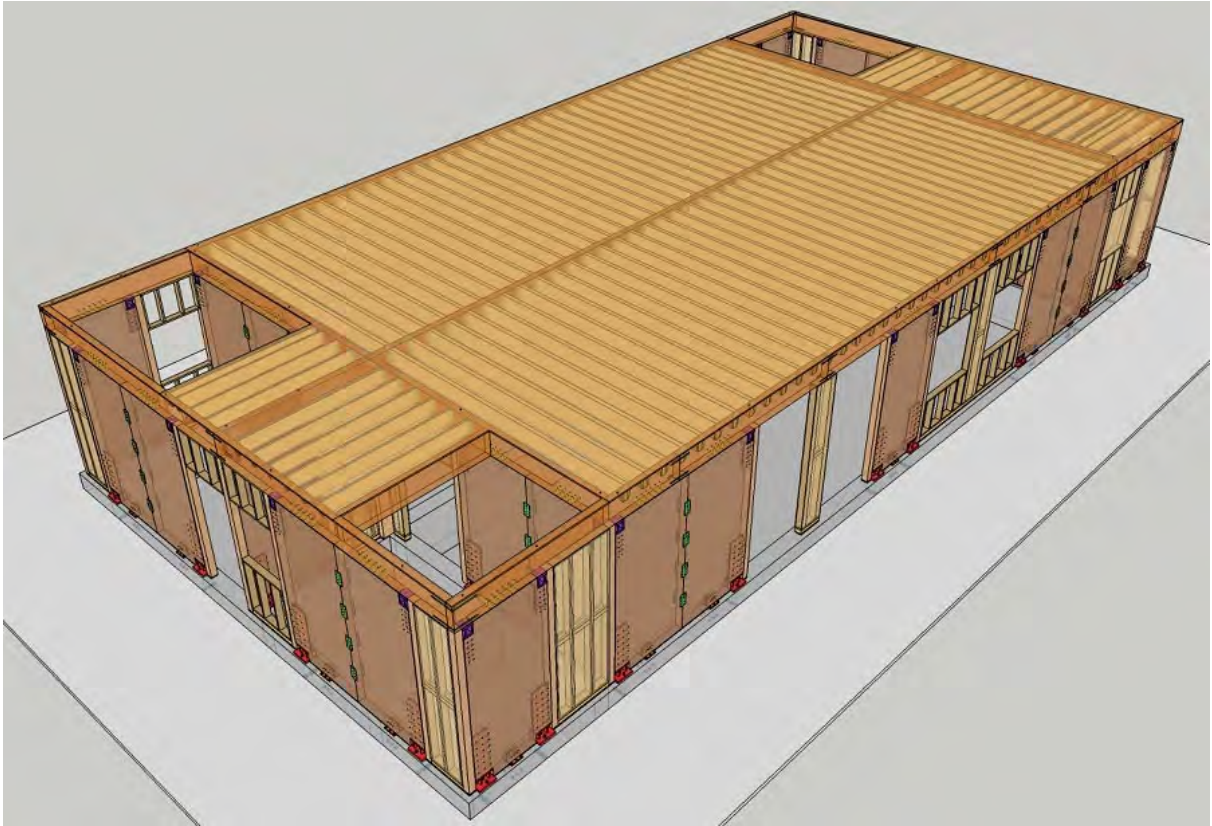
2階床合板張り
