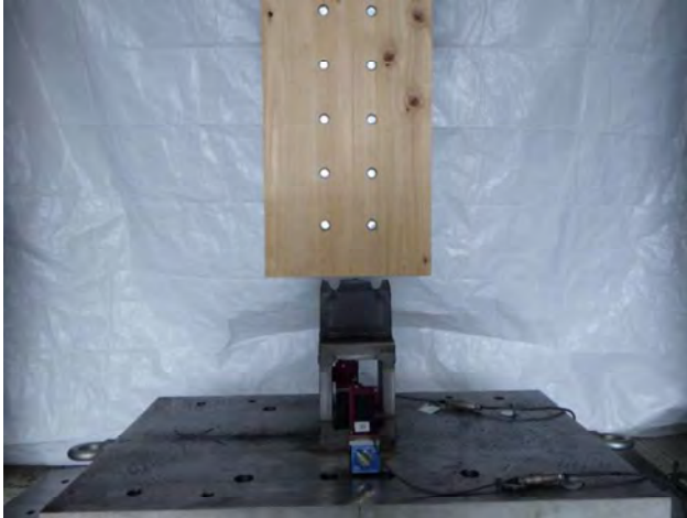
写真3 試験終了後の状況 (接合部試験体A, 単調)
