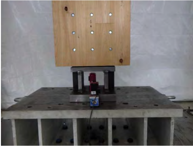
写真7 試験終了後の状況 (接合部試験体B, 単調)
