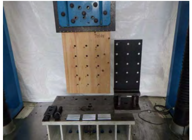
写真10 試験終了後の状況 (接合部試験体B, 一方向繰返し)
