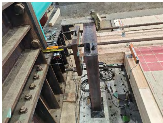
(2) 加力終了時 3層右側壁脚部
