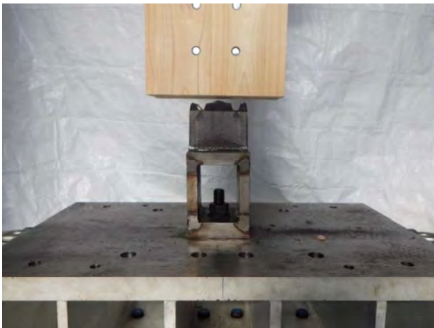
写真5 試験終了後の状況 (接合部試験体A, 一方向繰返し)
